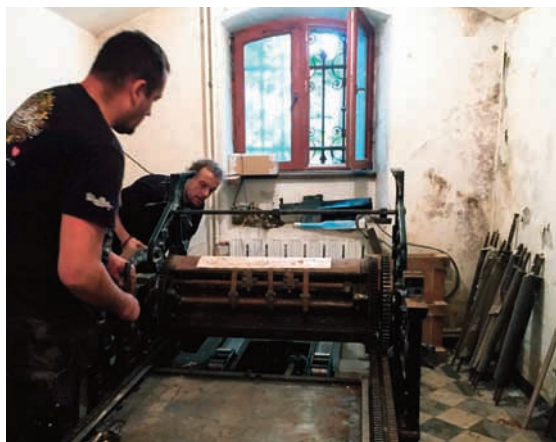
Fot. 12. Remont zabytkowej maszyny drukarskiej, tzw. stop-cylindrowej.
